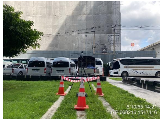
รูปที่ 22 การตรวจวัดระดับเสียงโดยทั่วไปและค่าความสัมพันธ์ บริเวณพื้นที่โครงการและบริเวณการไฟฟ้านครหลวง สำนักงานใหญ่ เขตคลองเตย
